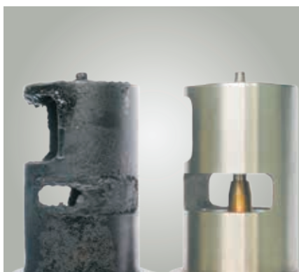
Da AGR-Ventile nicht von selbst verrosten können, muss nach den Ursachen des Rußes geforscht werden.
